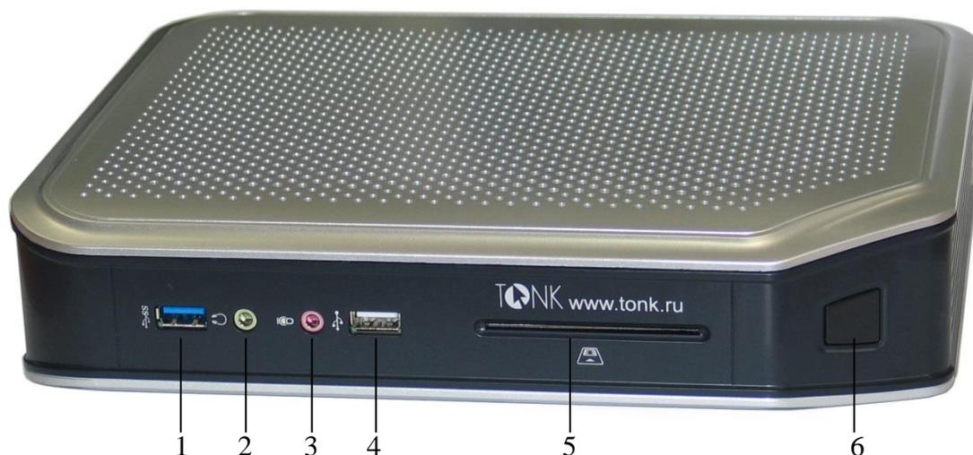
Рисунок 1 – Внешний вид передней панели системного блока
