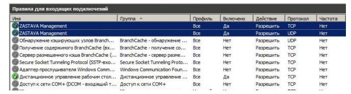
Рисунок 4 – Правила входящих подключений Брандмауэра Windows для Сервера ЦУП
