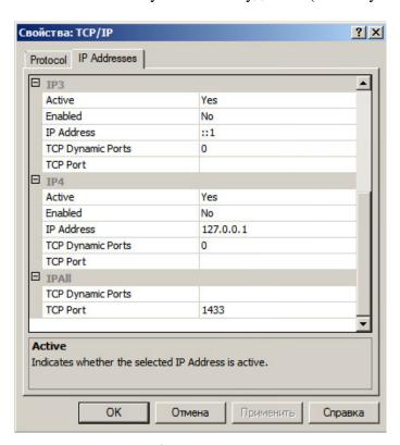
Рисунок 7 - Настройка TCP/IP при конфигурации MS SQL Server 2008 R2 Express Edition
