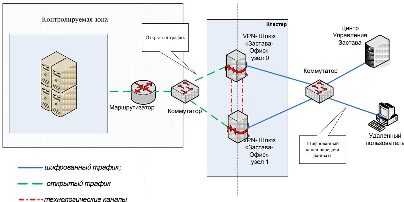
В качестве аппаратной платформы для VPN-шлюзов ЗАСТАВА-Офис, установленных на кластерном узле, могут использоваться как SPARC - серверы SUN Microsystems, так и компьютеры других производителей на Intel процессорах, иначе говоря, любые серверы на которых работает ОС SUN Solaris (SPARC и x86). В состав кластера могут входить до четырех однотипных узлов.
